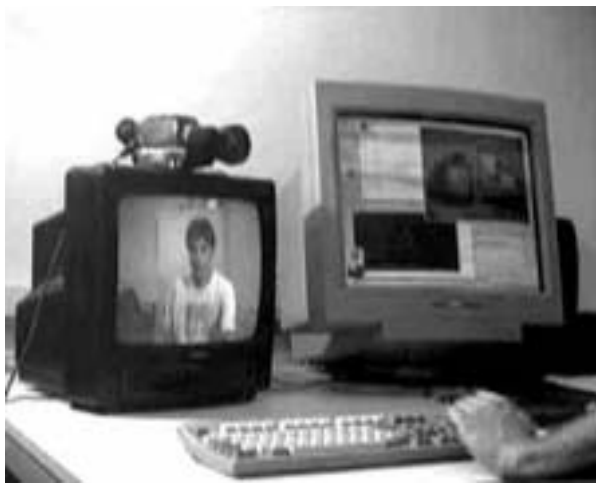
Figure 1 : Eléments typiques d'un noeud de mediaspace
