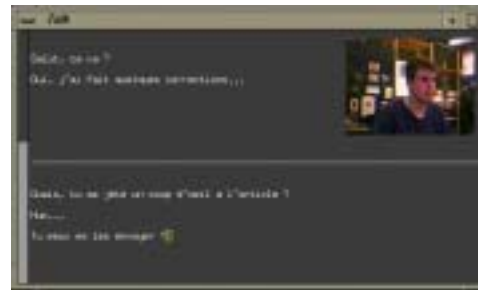
FIG. 4 – Vtalk, un talk augmenté : la fenêtre vidéo est fille de la fenêtre xterm dans la hiérarchie X-Window. Elle est donc déplacée et iconifiée avec celle-ci
