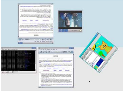
Figure 5 : Configuration pour une utilisation sur une table interactive. Un utilisateur est en train de déplacer la fenêtre montrant un dessin. Une autre fenêtre (un navigateur Web) a été dupliquée et passée de l'autre côté de la table.
